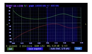
Еще одно нажатие на **ЦЕНТР** экрана - произойдет смена на график параметра S11 (в меню настроек – Configuration возможно отключить/включить показывать или не показывать этот график)
