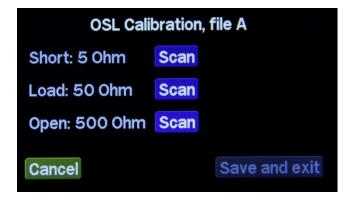
Подсоединяете поочередно нагрузки и проведите калибровку прибора. Подсоединив нагрузку 5 Ом – нажмите на кнопку Scan напротив надписи, ит.д.
