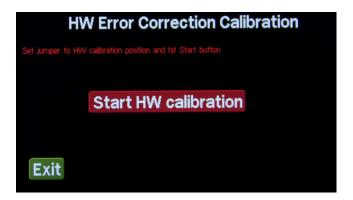
Для начала проведения калибровки, откройте заднюю крышку устройства и установите перемычку в положение «HW» на плате адаптера. Кроме этого, предварительно убедитесь, что установленные значения в основных настройках Configuration следующие:
