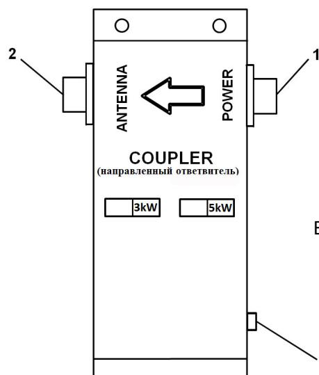
1. POWER - Вход сигнала с передатчика
