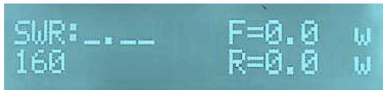
**F – падающая** мощность в Ваттах (**Мощность, которую выдает выходной каскад**)
