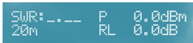
**Режим 4 - Режим Мощность в dBm и RL** - в этом режиме выводятся показания:
