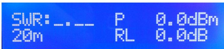
**Режим 4 - Режим Мощность в dBm и RL** - в этом режиме выводиться показания:
