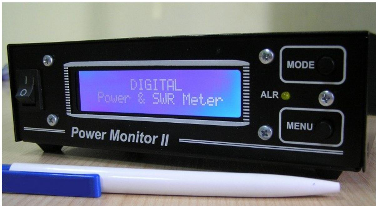
*Power Monitor II* – модернизированный вариант цифрового измерителя *Power Monitor* предназначенного для непрерывного измерения проходящей мощности в диапазоне 1,5 - 30Мгц, и КСВ в линии передачи. Кроме этого *Power Monitor II* является устройством защиты антенно-фидерного тракта в случае превышения заданного уровня мощности и устройством защиты передатчика в случае превышения заданного значения КСВ (блокирует работу передатчика). Индикация измеренных параметров производится на ЖКИ индикаторе.
