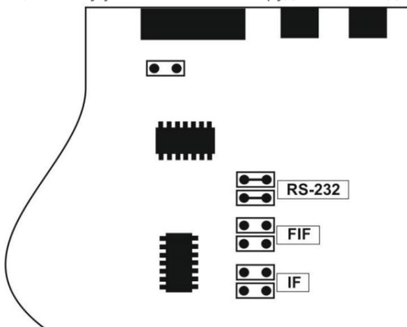
Для подключения трансиверов ICOM необходимо замкнуть переключатели используемые для протокола FIF232 и переключатель отдельно стоящую у разъема «To Radio» как показано на рисунке ниже.
