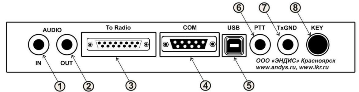
1. IN – выход, сигнал с трансивера в звуковую карту компьютера
